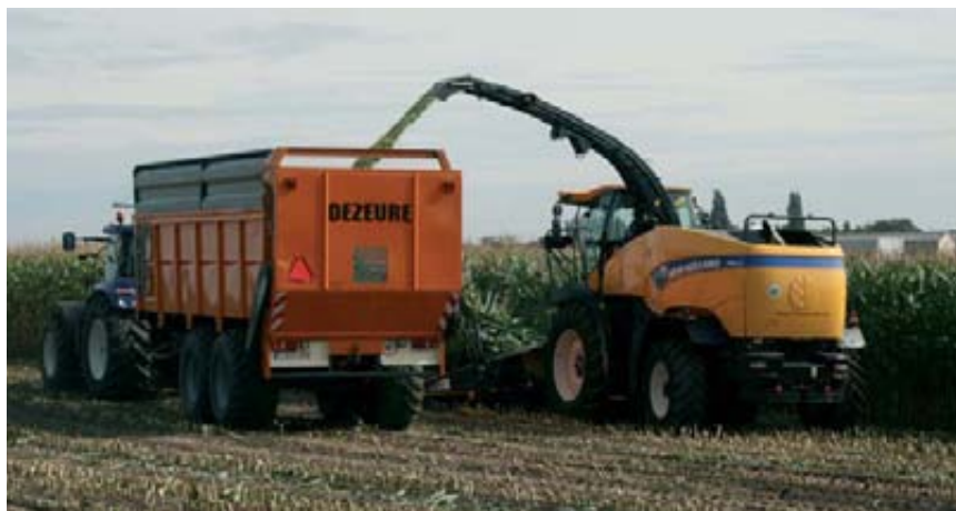
Izda: A partir de 2013 las picadoras de forraje FR podrán montar el sistema de llenado automático del remolque IntelliFill, que funciona con una cámara 3D que, como se aprecia en la foto, va montada en el canal de descarga. Dcha: Para las picadoras de forraje se han desarrollado además nuevos cabezales, como el 300 FP para hierba (en la foto).
