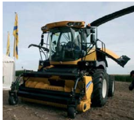
Izda: A partir de 2013 las picadoras de forraje FR podrán montar el sistema de llenado automático del remolque IntelliFill, que funciona con una cámara 3D que, como se aprecia en la foto, va montada en el canal de descarga. Dcha: Para las picadoras de forraje se han desarrollado además nuevos cabezales, como el 300 FP para hierba (en la foto).
