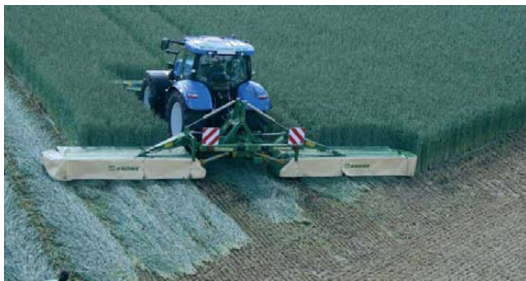
Segadora delantera EasyCut F 320 y segadora trasera EasyCut B 970.
