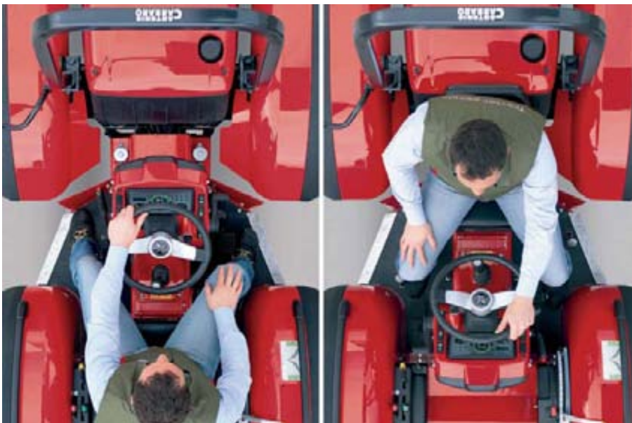
En la prueba pudimos invertir el sentido del conjunto asiento-columna de dirección y consola en solo 27 segundos, si bien el técnico de Antonio Carraro nos demostró que esta operación se puede hacer aún más deprisa.
