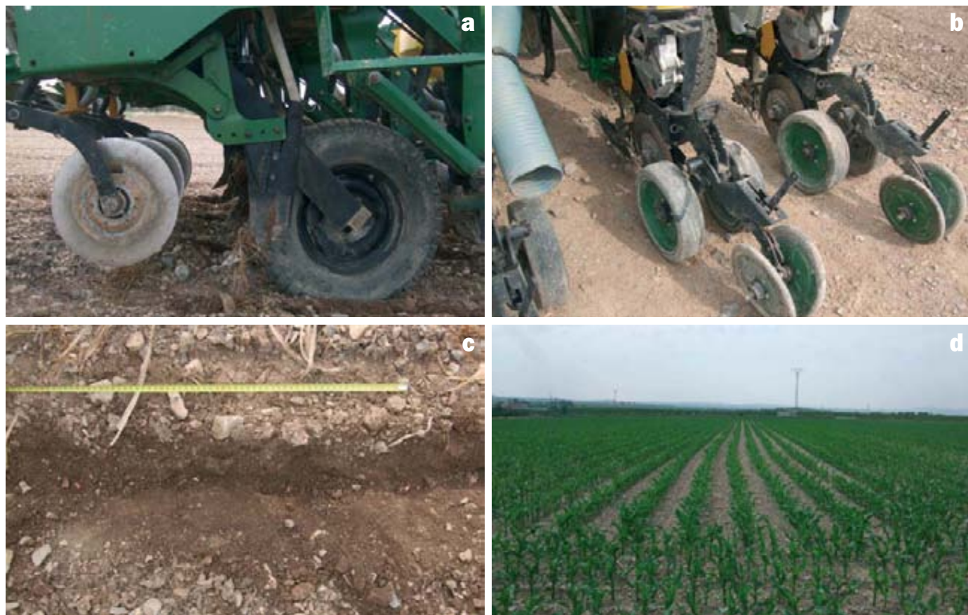
Foto 4. Detalles y resultados del equipo de siembra directa: a) abresurcos, b) cuerpo de siembra, c) semilla depositada y d) cultivo en desarrollo.
