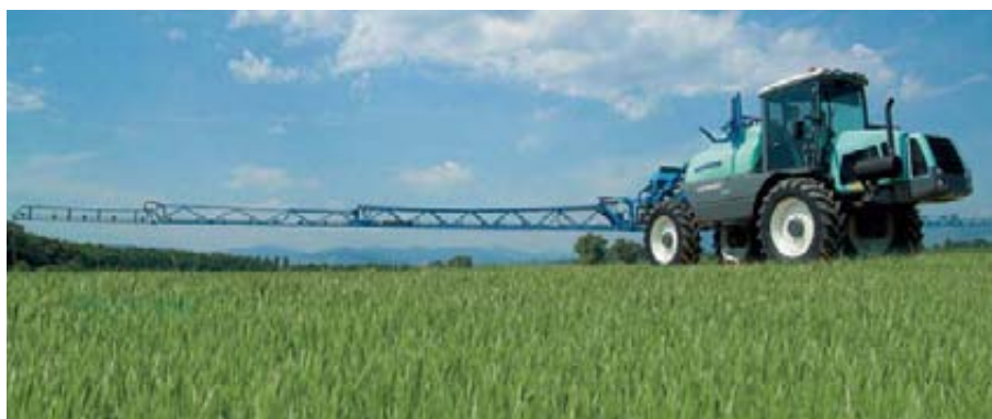
Foto 10. Modelo autopropulsado Raptor de Berthoud, que permite apreciar la estilización (ligereza) de las barras, manteniendo una máxima solidez.
