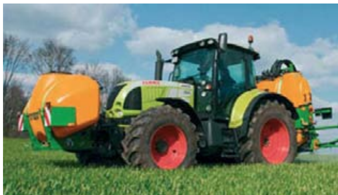
Foto 7. Pulverizador suspendido con depósito auxiliar frontal, que puede cargar por encima de los 1.000 l de líquido.
