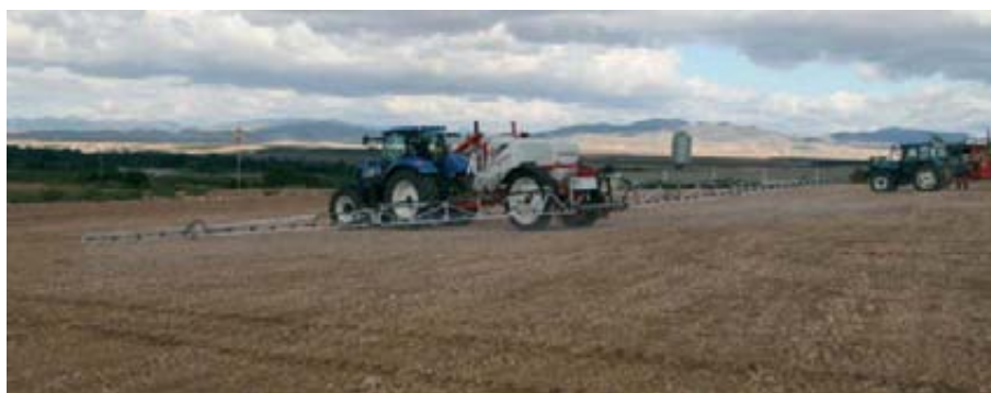
Foto 11. Las demostraciones de maquinaria permiten apreciar el trabajo real de las máquinas. En este caso un pulverizador de barras Kuhn del que vemos la anchura de trabajo y el mezclador automático de producto.
