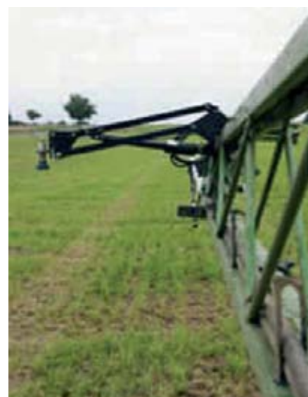
Foto 8. Detalle del sensor Agri Con que determina la cantidad de biomasa y permite modular el caudal de pulverización.
