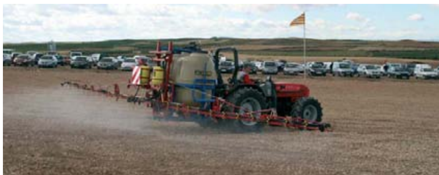
Foto 12. Pulverizador de barras Aguirre en una demostración de maquinaria. Se pueden apreciar los depósitos auxiliares de agua limpia y los marcadores de espuma.
