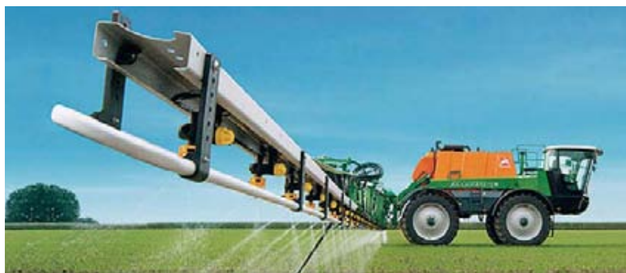
Foto 6. Vehículo automotor de Amazone en pleno trabajo. Se aprecia la solidez de la estructura de la barra.
