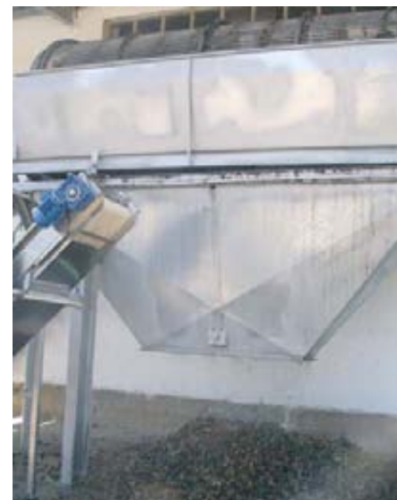
Foto 1. Vibrador de nogales autopropulsado. Foto 2 (dcha.). Limpieza gruesa antes de la entrada en la cadena de acondicionamiento de la nuez.
