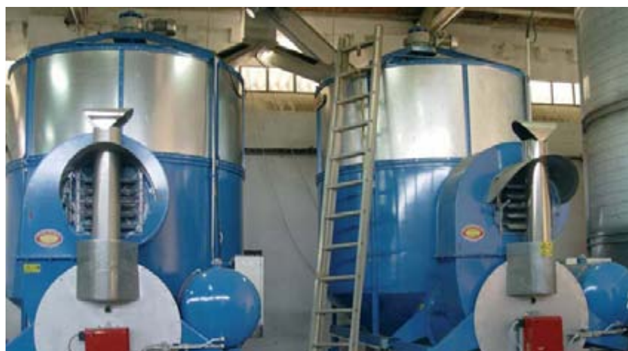
Foto 6. Secaderos verticales de paredes rígidas, con movimiento de masa de las nueces y control de humedad.
