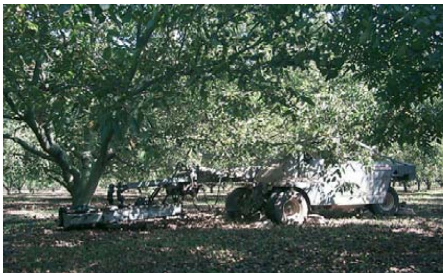
Foto 1. Vibrador de nogales autopropulsado. Foto 2 (dcha.). Limpieza gruesa antes de la entrada en la cadena de acondicionamiento de la nuez.
