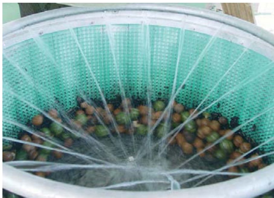
Foto 4. Lavadora-peladora de nueces.
