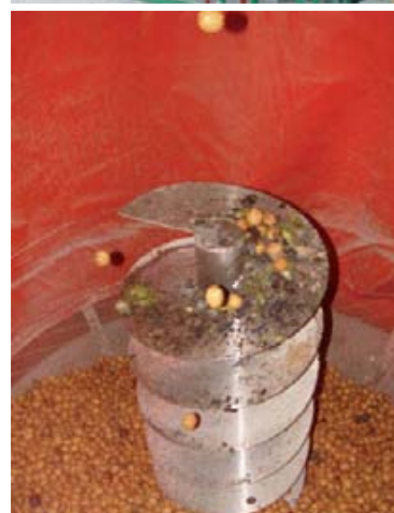
Foto 5. Secaderos verticales de paredes de lona plastificada, con movimiento de la masa de nueces y control de humedad. Abajo, detalle del sistema de movimiento.
