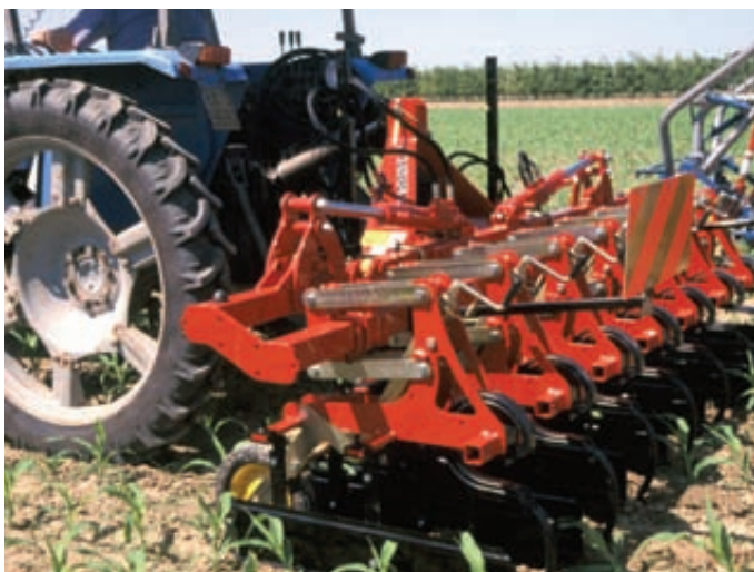
Fotos 5 y 6. Aricadora de pantallas (foto izquierda) y aricadora rotativa (foto derecha) para la escarda mecánica en maíz.
