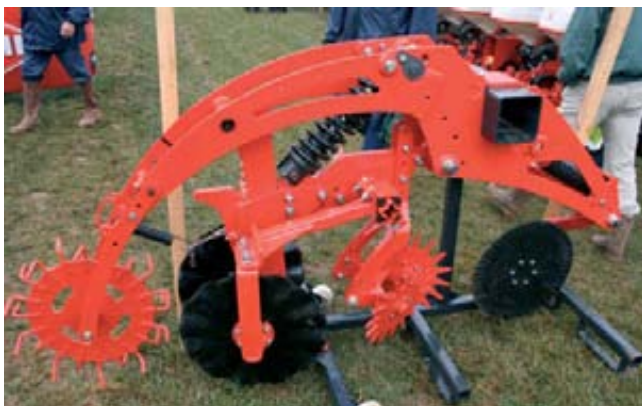
Foto 9. Cuerpo del apero Stríger (Kuhn) para la realización de laboreo en bandas.
