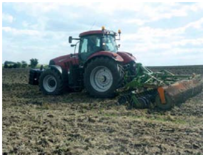
Foto 4. Cultivador con brazos de reja equipado con discos de estrella y rodillo tipo jaula. Foto 5 (derecha). Grada de discos rápida.
