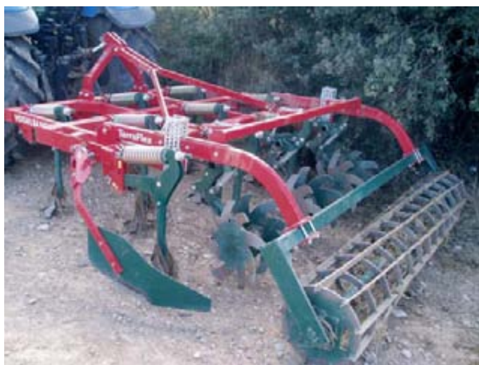
Foto 4. Cultivador con brazos de reja equipado con discos de estrella y rodillo tipo jaula. Foto 5 (derecha). Grada de discos rápida.
