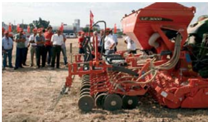
Combiliner Venta LC 3000 con barra de siembra Seedflex, que se compone de un doble disco de siembra, seguido de una rueda de compactación.
