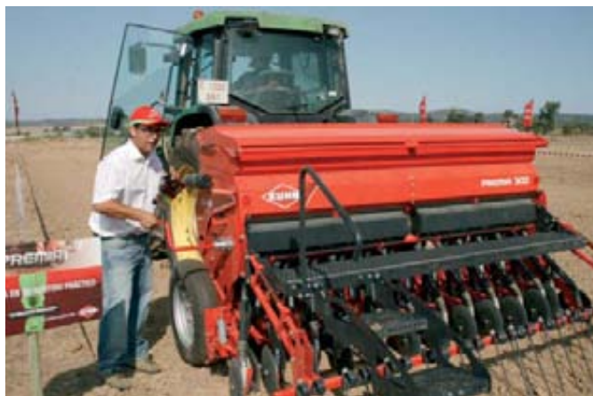
Con una palanca se pueden abrir y cerrar las acanaladuras del sistema de distribución de la Premia 300, así como regular centralizadamente la profundidad de los discos de siembra.
