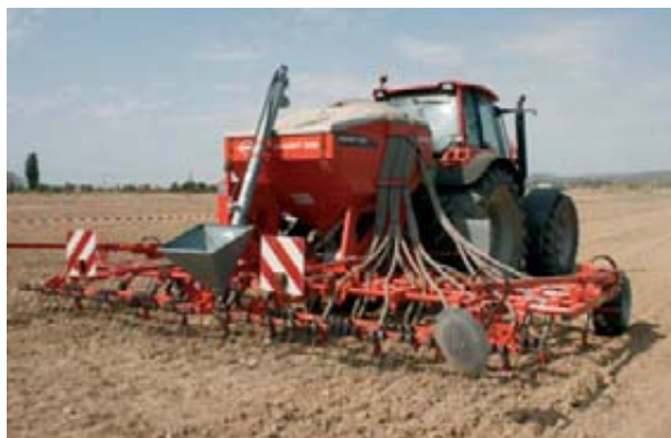
La sembradora Megant 600 tiene una anchura de trabajo de 6 metros plegables a 3 m para su transporte por carretera, lo que a su vez facilita el acceso al dosificador.
