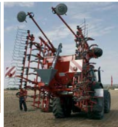
La sembradora Megant 600 tiene una anchura de trabajo de 6 metros plegables a 3 m para su transporte por carretera, lo que a su vez facilita el acceso al dosificador.
