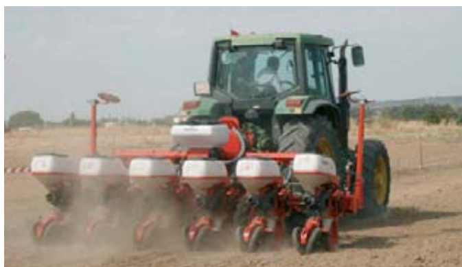
La sembradora Máxima 2 TD presenta una regulación extremadamente sencilla frente a otras sembradoras monograno, aunque se hace igualmente cuerpo por cuerpo.
