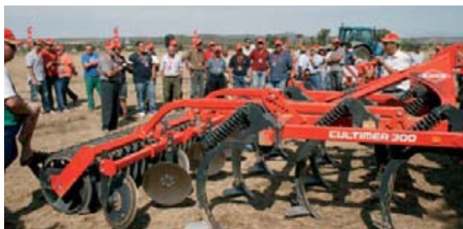
Cultimer 300 es un apero rastrojador polivalente especialmente indicado para poder hacer una siembra de cereal después de una cosecha de maíz.
