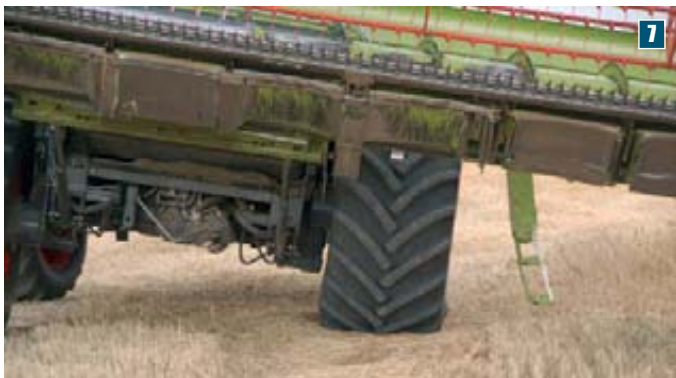
Fotos 7 y 8. Inclinación de la Montana para descargar.
