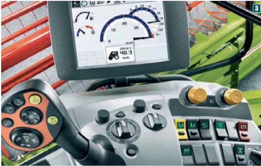
Foto 3. Vista del pupitre de mando, mando multifuncional y pantalla del Cebis.
