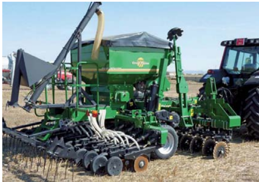
Foto 2. Sembradora de siembra directa neumática con sistema de apertura de surco por discos.
