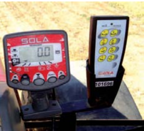
Foto 3. Sistema de control electrónico del funcionamiento de la sembradora.
