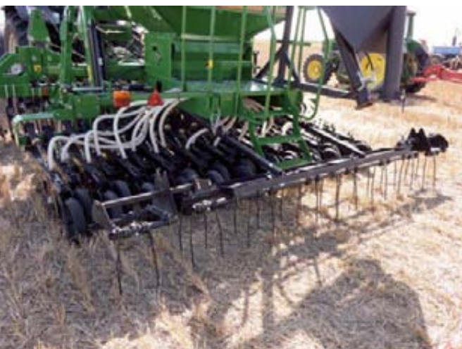
Foto 7. Sistema de cobertura mediante grada con púas flexibles.
