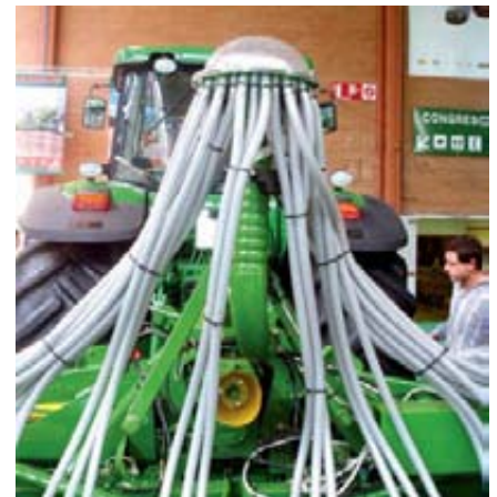
Foto 5. Sistema de dosificación centralizada con distribución neumática.
