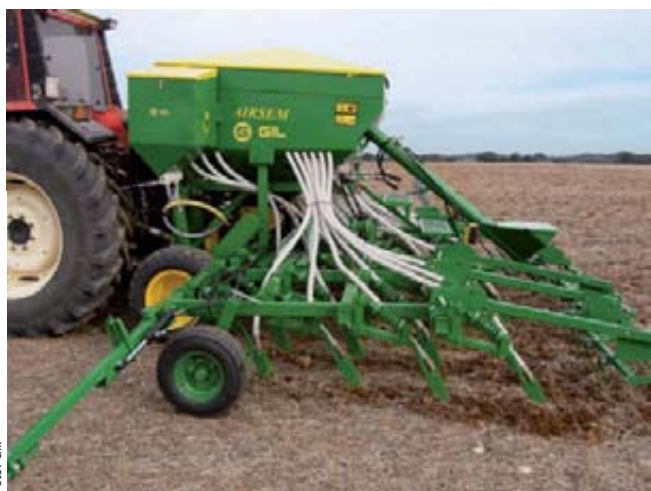
Foto 9. Sembradora neumática a chorrillo con depósito adicional para producto microgranulado.
