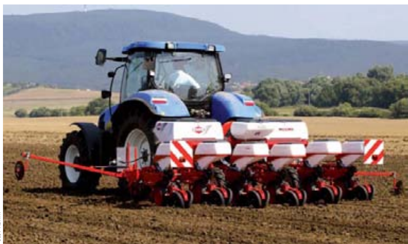
Foto 10. Sembradora monograno con depósitos adicionales para fertilizante e insecticida granulados. Documentación Kuhn.
