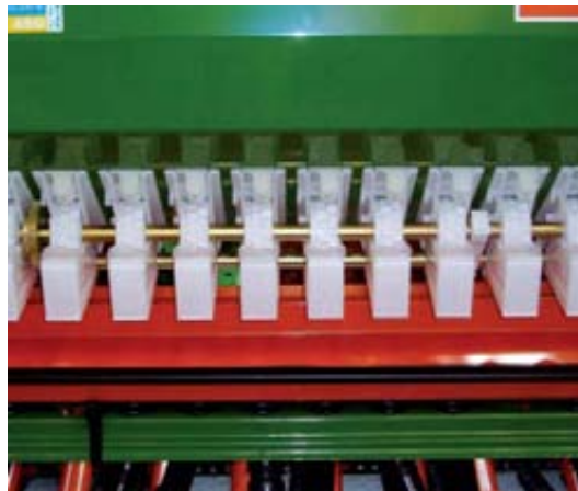
Foto 4. Sistema dosificador de rueda dentada en sembradora a chorrillo.
