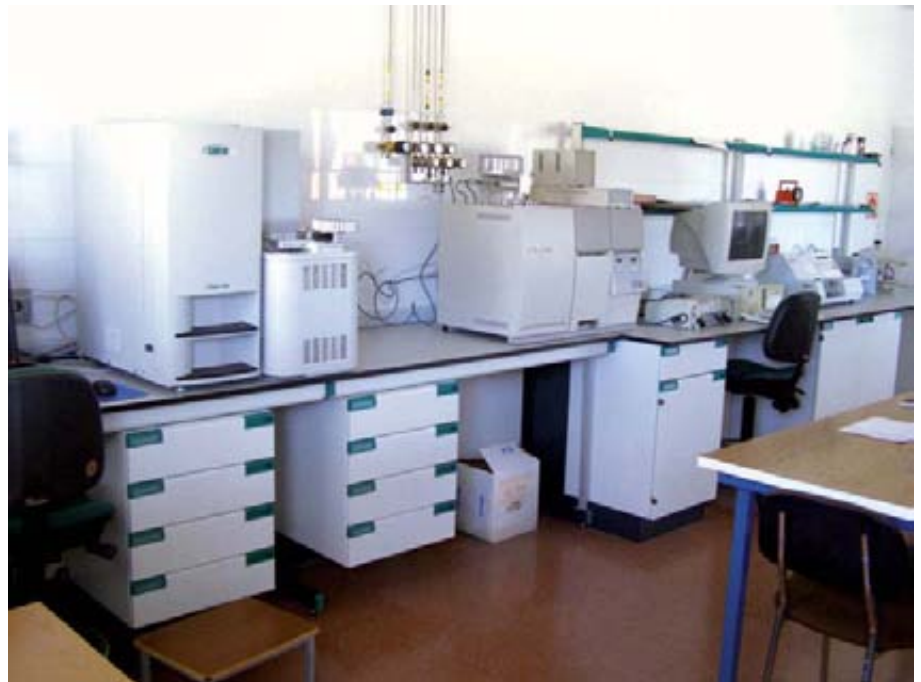
Módulo de análisis elemental (C, H, N) del Laboratorio de Caracterización de Biomasa del CEDER-CIEMAT.
