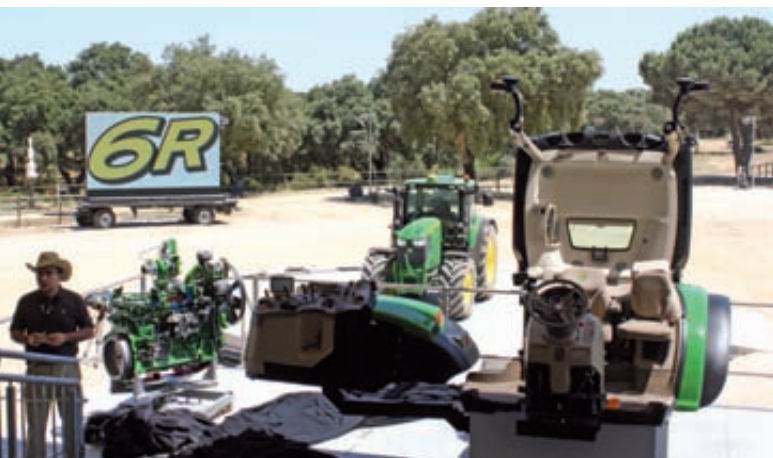
Tres nuevos modelos de la serie 6R de entre 170 y 210 CV que cumplen con la normativa de emisiones fase IIIB (EGR + filtro de partículas), suspensión hidroneumática de la cabina y suspensión del eje delantero, entre otras características.
