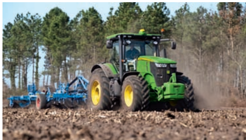
Presentación en campo de la serie 7R formada por cinco nuevos modelos de entre 200 y 280 CV, que montan motores PowerTech PVX de 9 litros los tres modelos de mayor potencia y PowerTech PSX de 6,8 litros los dos más pequeños. La serie ofrece cuatro tecnologías de transmisión, cabina Command View II y todas las opciones de agricultura de precisión de la marca.
