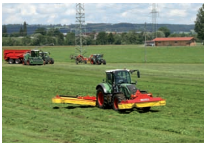
Con una relación peso-potencia de 32,9 kg/CV y una distancia entre ejes de 2.770 mm, el 700 Vario se presenta como el nuevo tractor compacto de alta potencia.
