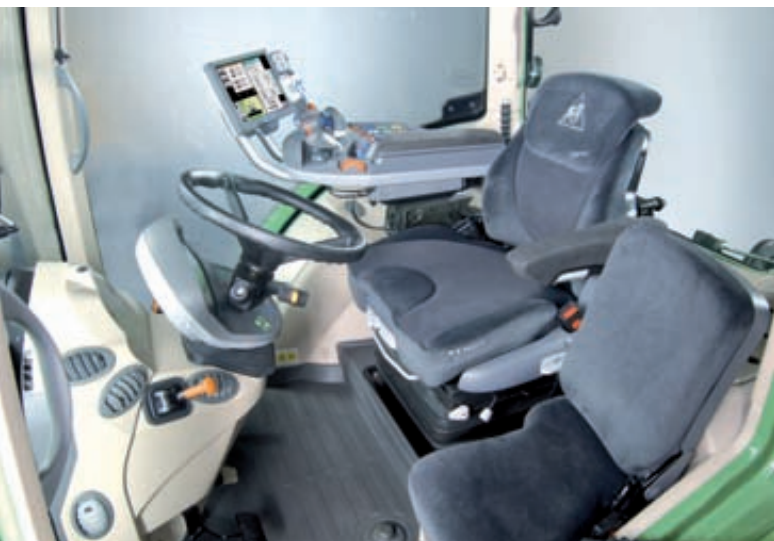
Los 700 Vario montarán de serie el control de mando Fendt Variotronic, de las series 800 y 900 Vario, y opcionalmente el asiento superconfort Evolution.
