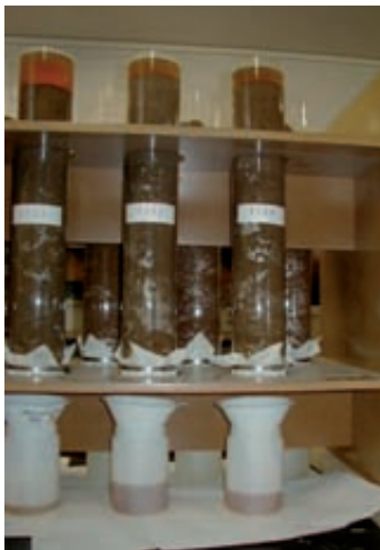
Fotos 3. Columnas de lixiviación para determinar en laboratorio las pérdidas por percolación de calcio o magnesio.
