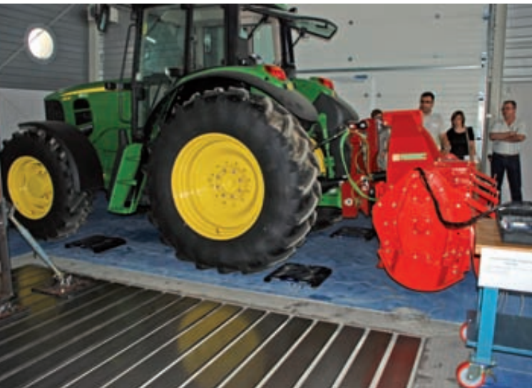
Sistema de control de los esfuerzos transmitidos a través de la toma de fuerza.
