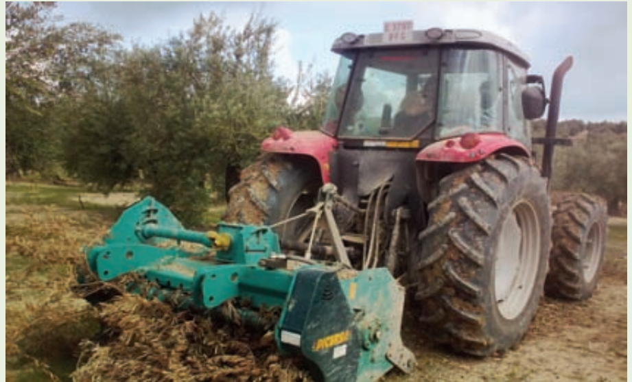
Para triturar los restos de poda situados en el centro de las calles, el tractor necesita de velocidades lentas o creeper que le permitan alimentar uniformemente la trituradora y realizar un buen picado.
