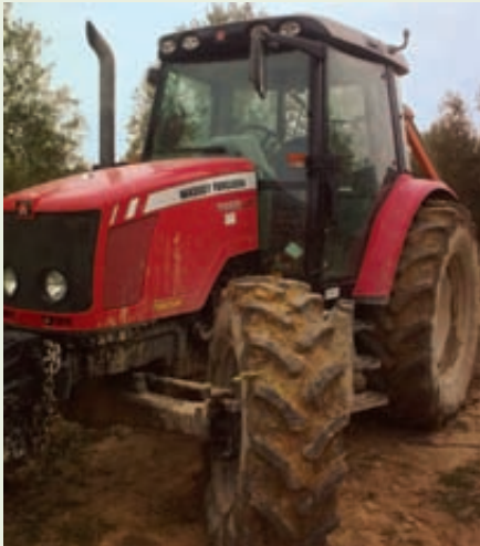
Un aspecto a considerar es la robustez del puente delantero, para soportar la carga del conjunto vibrador y paraguas. Massey Ferguson monta ejes de diferente tamaño adecuados a la potencia y el trabajo que va a desarrollar cada modelo.
