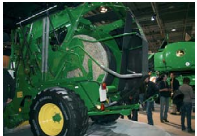
La supresión del portón trasero ha contribuido a la reducción del tiempo de expulsión de la paca en las rotoempacadoras 990 y 960 John Deere premiadas.
