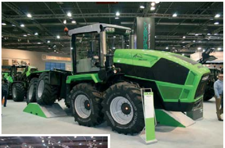
Entre otras novedades, Same Deutz-Fahr exponía en su stand el AgroXXL, dotado con cuatro ejes de tracción y hasta 600 CV de potencia.
