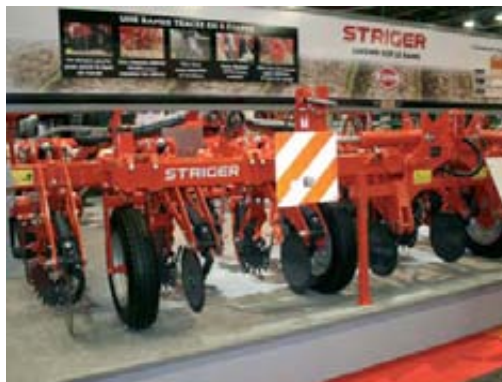
El nuevo apero de Kuhn permite, entre otras cosas, la aplicación del abono bajo la línea de siembra.
