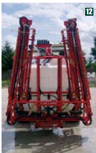
Foto 12. Barra de pulverización plegada para transporte.
