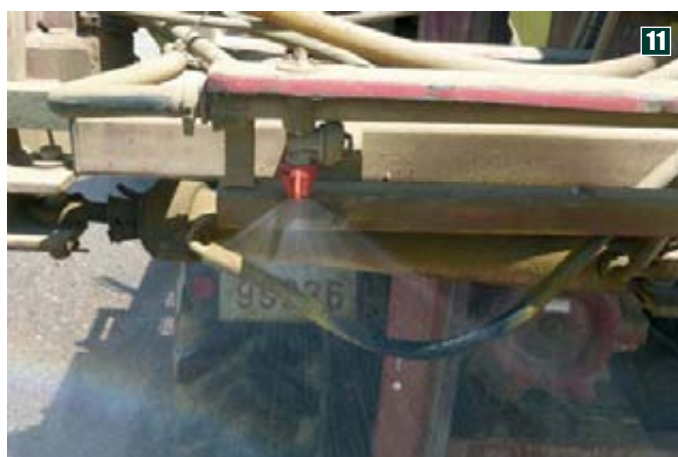
Foto 8. Detalle de bomba de membranas. Foto 9. Comprobación del manómetro del pulverizador utilizando un manómetro de referencia. Foto 10. Sistema de regulación de los sectores de pulverización. Foto 11. Conducción colocada inadecuadamente en la trayectoria de las gotas generadas por la boquilla.
