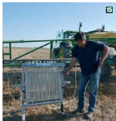
Foto 13. Cabezal con diferentes boquillas para uso rápido. Foto 14. Boquilla deteriorada. Foto 15. Medición del caudal aportado por las boquillas de la barra.
