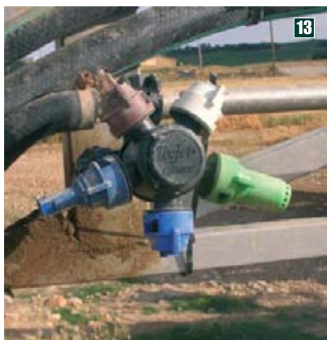
Foto 13. Cabezal con diferentes boquillas para uso rápido. Foto 14. Boquilla deteriorada. Foto 15. Medición del caudal aportado por las boquillas de la barra.
