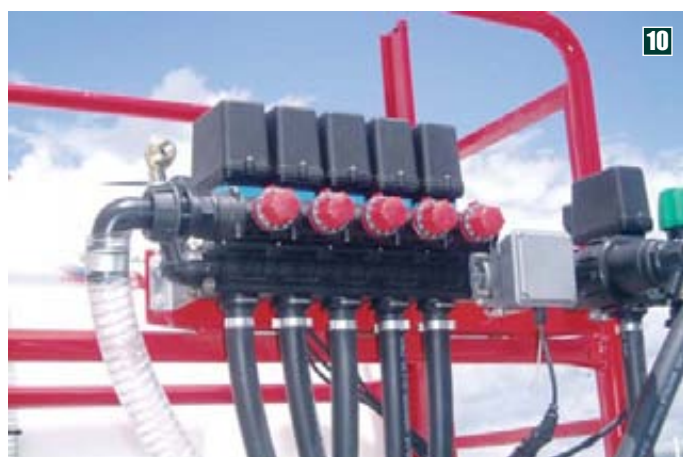
Foto 8. Detalle de bomba de membranas. Foto 9. Comprobación del manómetro del pulverizador utilizando un manómetro de referencia. Foto 10. Sistema de regulación de los sectores de pulverización. Foto 11. Conducción colocada inadecuadamente en la trayectoria de las gotas generadas por la boquilla.
