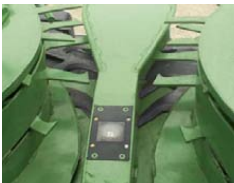
Foto 6. Palpador para autoguiado en cabezal de maíz forrajero. Documentación John Deere. Foto 7. Sensor óptico AutoScan para la determinación de madurez ubicado en cabezal de siega. Documentación Krone.
