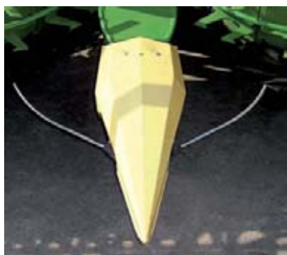
Foto 6. Palpador para autoguiado en cabezal de maíz forrajero. Documentación John Deere. Foto 7. Sensor óptico AutoScan para la determinación de madurez ubicado en cabezal de siega. Documentación Krone.
