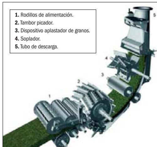
FIGURA 1. Sistema alimentador-picador-conductor del forraje.
