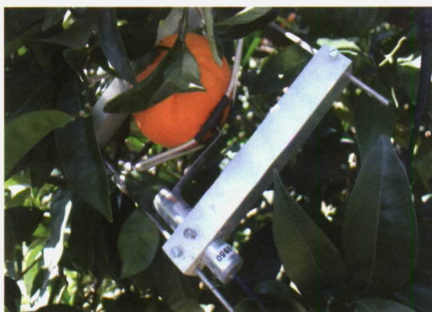
Arriba, vista general de un dendrómetro de tronco. En la foto inferior, vista general de un dendrómetro de fruto.
