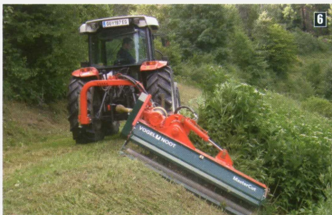
Foto 6. Trituradora para desbrozado de laderas.
