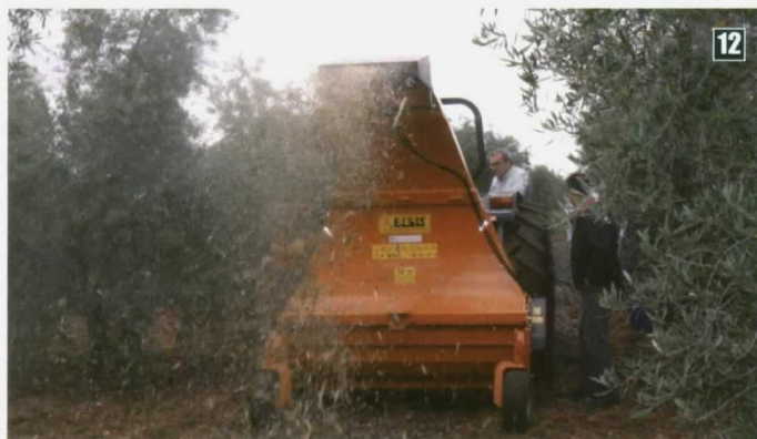
Foto 10. Trituradora que incorpora una tolva desde la que se descarga al remolque para su utilización con fines energéticos.
