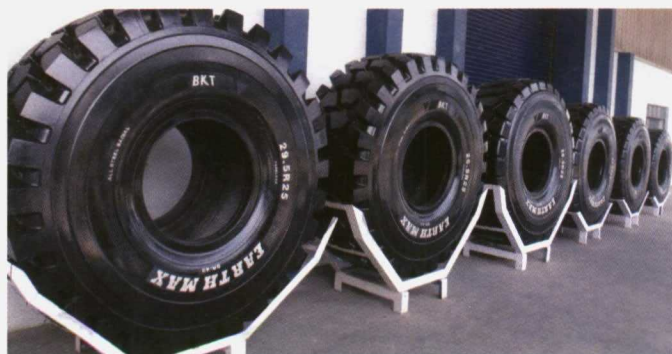
El Earthmax 23.5R25 fue el primer neumático todoterreno de BKT con carcasa y cintas de acero.
