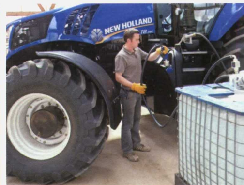
Ubicación del sistema SCR en el escape del tractor y llenado del depósito de AdBlue (que se encuentra junto al depósito de combustible).
