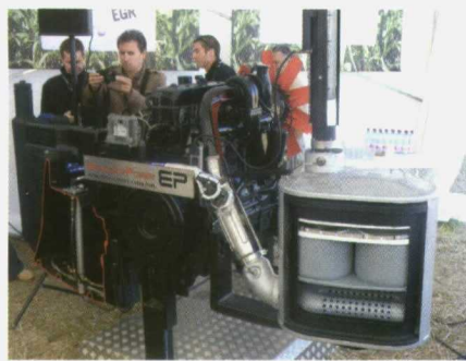
Sistema EfficientPower para depuración de gases de escape. A la izquierda se puede observar el depósito para incorporar el producto AdBlue y a la derecha la zona donde se mezcla con los gases de escape del motor para producir la reacción química de descomposición de los óxidos nítricos.
