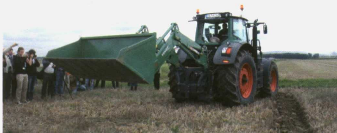
Cargo R, el cargador trasero para tractores grandes.
