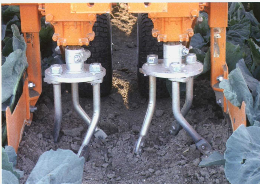
Foto 2. Rotocultor de eje vertical con túnel de protección del cultivo (Struik Wieringermeer BV).
