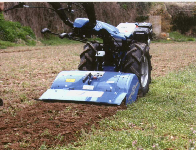
Aspecto posterior de la máquina en la que se aprecian los mandos de la caja de cambios y de la tdf y la regulación de profundidad.
