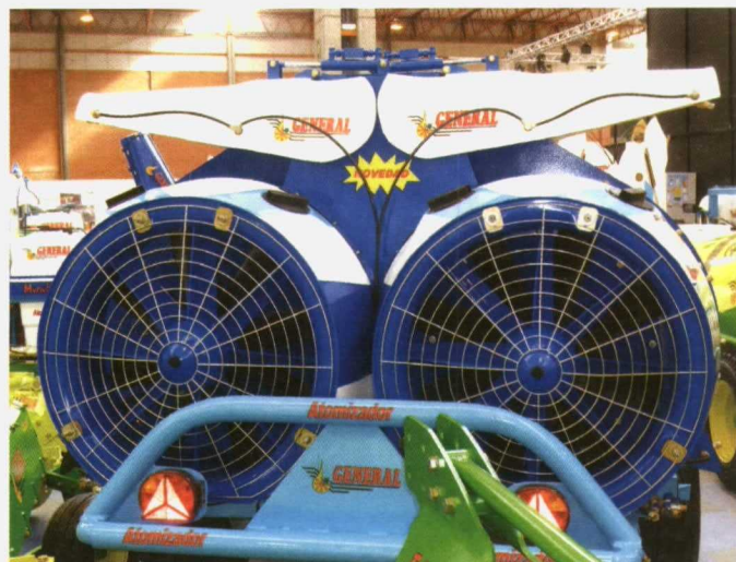
Foto 8. Sistema de ventilación constituido por dos ventiladores en paralelo desarrollado por General.
