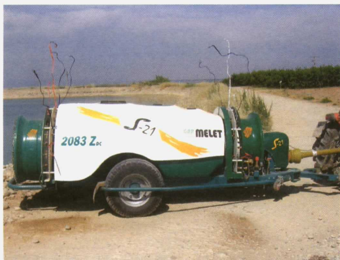
Foto 7. Pulverizador hidroneumático de Gar Melet equipado con dos ventiladores (anterior y posterior) con sentido de giro opuesto.
