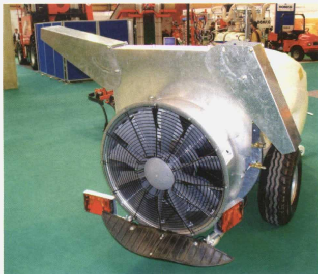
Foto 5. Atomizador equipado con deflector para dirigir el flujo de aire a una zona concreta de la vegetación.
