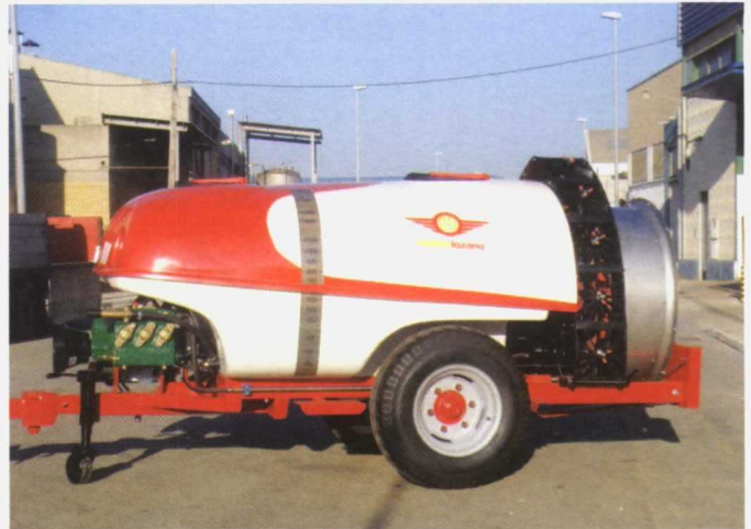
Foto 4. El sistema Twister de Mañez y Lozano consiste en un nuevo modelo de ventilador que genera una salida de aire que, en lugar de ser directa, forma turbulencias.
