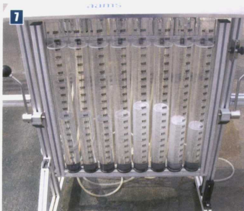
Foto 7. Detalle de medida de caudal de diferentes boquillas.
