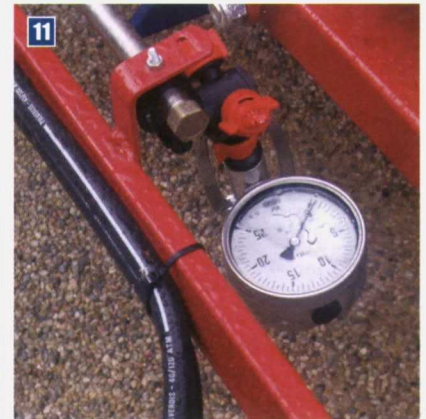
Foto 11. Colocación de un manómetro en el pulverizador para medir la presión de un determinado sector de la máquina.
