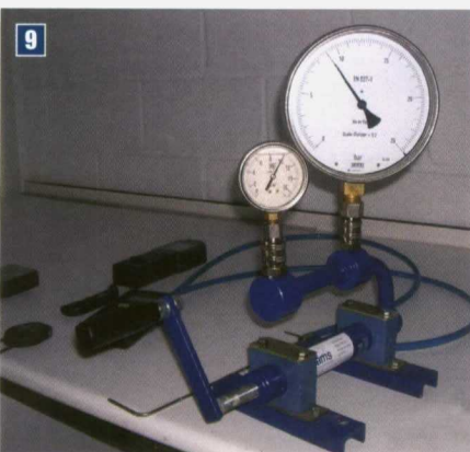
Foto 9. Contraste del manómetro del pulverizador con un manómetro de referencia.
