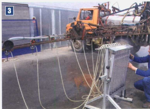
Foto 2. Ensayo de distribución en campo con papel hidrosensible y papel de filtro.
