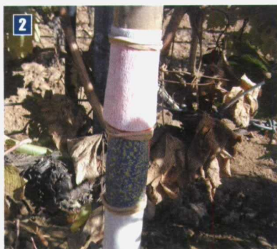
Foto 2. Ensayo de distribución en campo con papel hidrosensible y papel de filtro.
