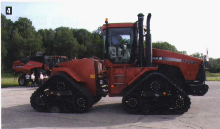
Foto 4. Case IH tiene un modelo de alta potencia el STX Quadtrac de orugas con 530 CV.
