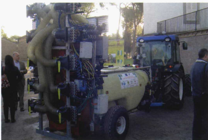
Prototipo de pulverizador hidroneumático proyecto Isafruit (CASA).
