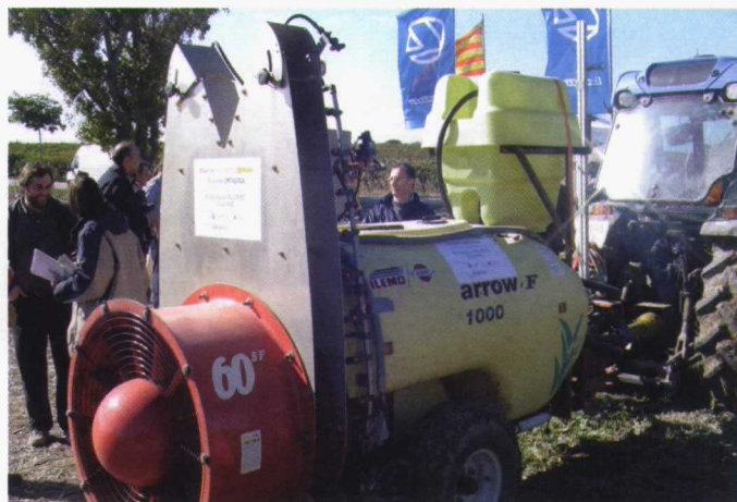
Pulverizador para frutales equipado con dispositivos Optidosa.
