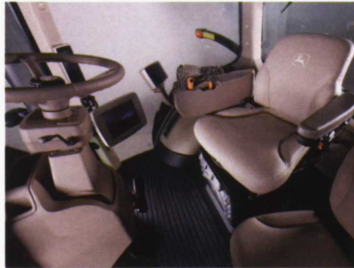
Foto 1 (Izda.). Cabina CommandView II. Foto 2 (derecha). Vista desde el punto de conducción del mando de control CommandArm y la pantalla de control CommandCenter.
