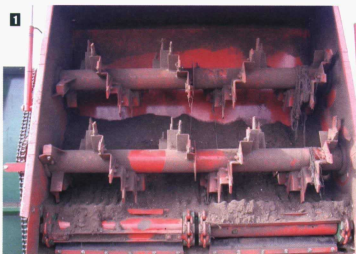
Foto 1. Vista de rotores horizontales de esparcidor de estiércol sólido. Documentación Strautmann. Foto 2. Vista de rotores verticales de esparcidor de estiércol sólido. Documentación Mazas Maquinaria.
