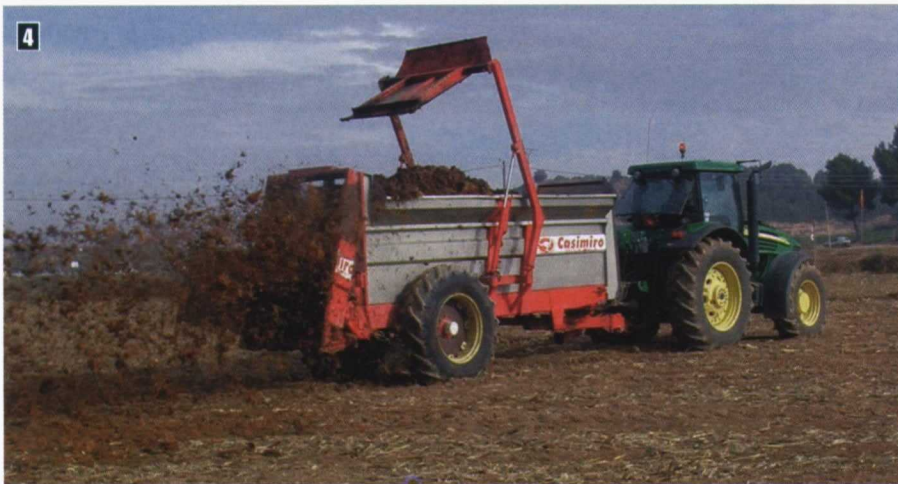
Foto 3 y 4. Esparcidor de estiércol sólido con rotores verticales. Documentación Joskin (foto 3) y Francosi (foto 4).
