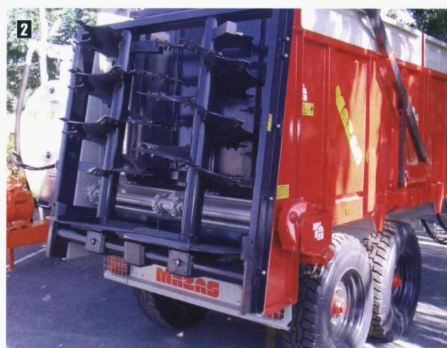
Foto 1. Vista de rotores horizontales de esparcidor de estiércol sólido. Documentación Strautmann. Foto 2. Vista de rotores verticales de esparcidor de estiércol sólido. Documentación Mazas Maquinaria.
