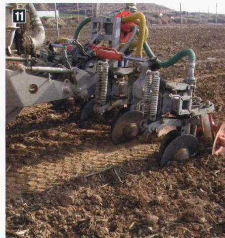
Foto 10 y 11. Detalle de distribución realizada por sistema de aplicación de doble disco. Documentación Kuhn. (foto 10) y Pichón (foto 11).
