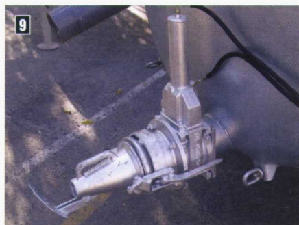
Foto 9. Sistema de distribución con plato de choque para estiércol líquido.
