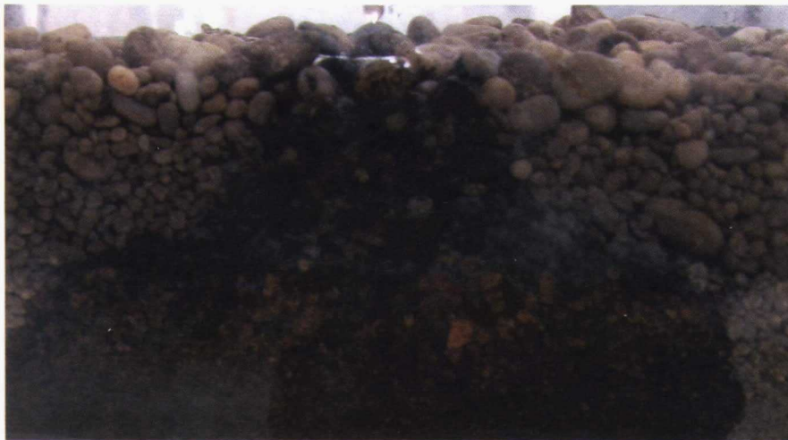
Foto 2. Acolchado de grava sobre sustrato con infiltración moderadamente buena. Obsérvese, no obstante, cómo en la interfase entre la grava y el sustrato subyacente se produce un ensanchamiento considerable de la superficie mojada. También puede apreciarse el incremento progresivo del tamaño del área mojada desde la superficie del acolchado hasta la interfase, dado que sus poros se van saturando.
