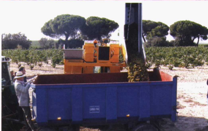
Gracias al sistema de rótula articulada y a la central hidráulica integrada en el chasis la vendimiadora arrastrada G1 de Gregoire ofrece una maniobrabilidad que permite reducir tiempos muertos y optimizar su productividad.
