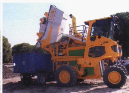
La vendimiadora autopropulsada Gregoire G8 monta una nueva cabina, más grande y que permite mayor visibilidad e insonorización
