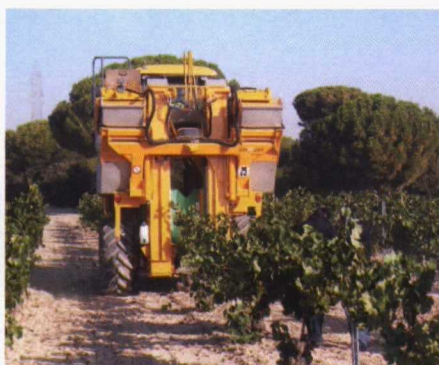
La vendimiadora autopropulsada Gregoire G8 monta una nueva cabina, más grande y que permite mayor visibilidad e insonorización
