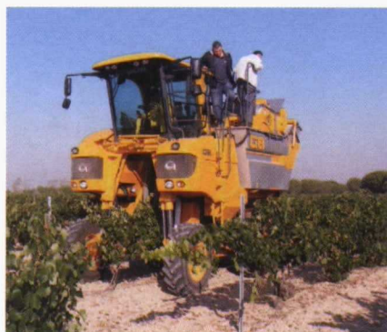
La vendimiadora autopropulsada Gregoire G8 monta una nueva cabina, más grande y que permite mayor visibilidad e insonorización
