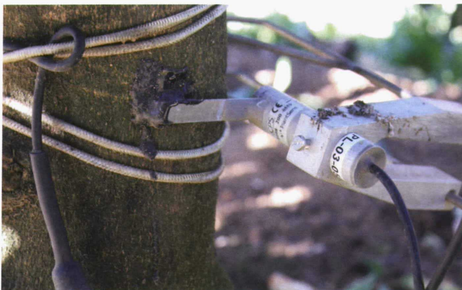
Foto 1. Vista general de un dendrómetro de tronco.
