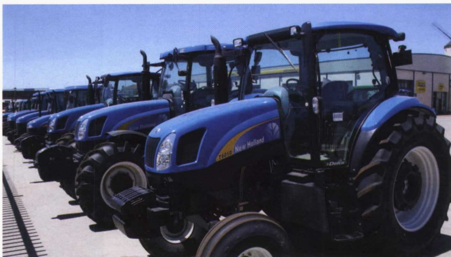
Uno de los modelos de tractores más vendidos en la zona es el T6010 con el chasis elevado para el cultivo de la viña.
