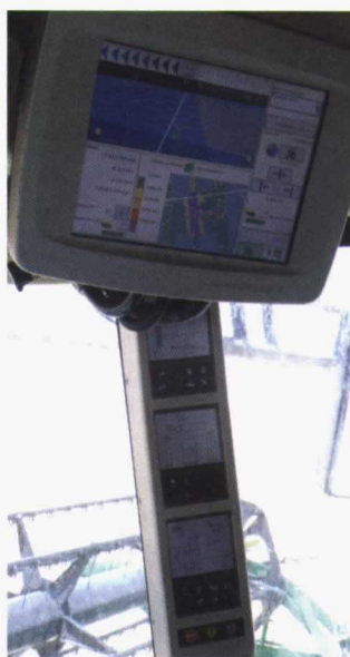
Monitor GreenStar 2600 indicando la línea de guiado automático de la cosechadora y los distintos parámetros de cosecha.
