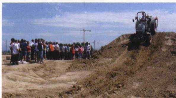
La transmisión Vario permite incrementar la seguridad en parada activa en grandes desniveles, sin necesidad de actuar con el embrague.
