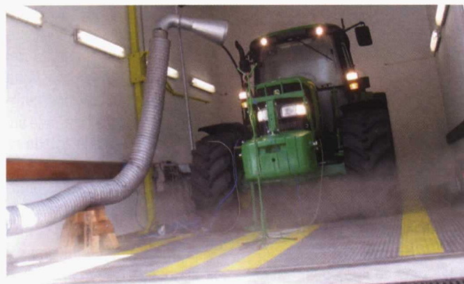
Sala refrigerada para comprobar el funcionamiento a bajas temperaturas.
