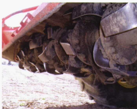
Foto 9 (abajo). Fresadora o rotovátor con azadas curvadas accionada por la tdf.
