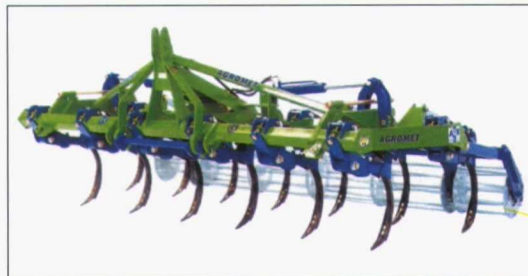
Foto 2 (izda.). Apero de labranza vertical tipo chisel. Foto 3 (derecha). Chisel.
