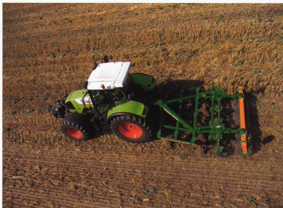
Foto 6. Cultivador con brazos de reja equipado con discos de estrella y rodillo tipo jaula.
