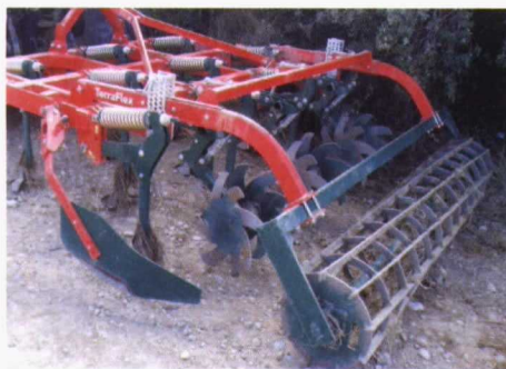
Foto 6. Cultivador con brazos de reja equipado con discos de estrella y rodillo tipo jaula.
