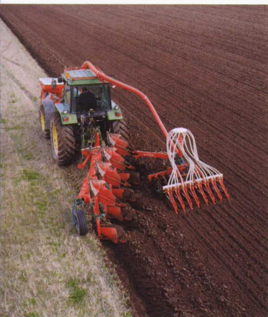
Foto 8 (izda.). Equipo multilabor capaz de realizar laboreo primario, laboreo secundario y siembra en una sola pasada.
