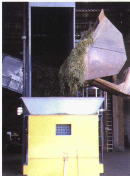
Foto 2. Introducción del forraje en el alimentador para iniciar el proceso de secado. Documentación Agro-Pirineos Ayerbe.
