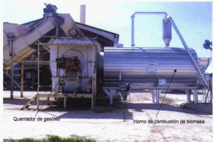
Foto 3. Quemador de gas. Documentación Agro-Pirineos Ayerbe. Foto 4. Horno de combustión de biomasa acoplado lateralmente a un horno de gasóleo, cuyo quemador (en rojo), se observa en primer plano.
