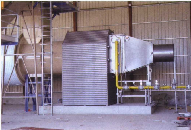
Foto 3. Quemador de gas. Documentación Agro-Pirineos Ayerbe. Foto 4. Horno de combustión de biomasa acoplado lateralmente a un horno de gasóleo, cuyo quemador (en rojo), se observa en primer plano.
