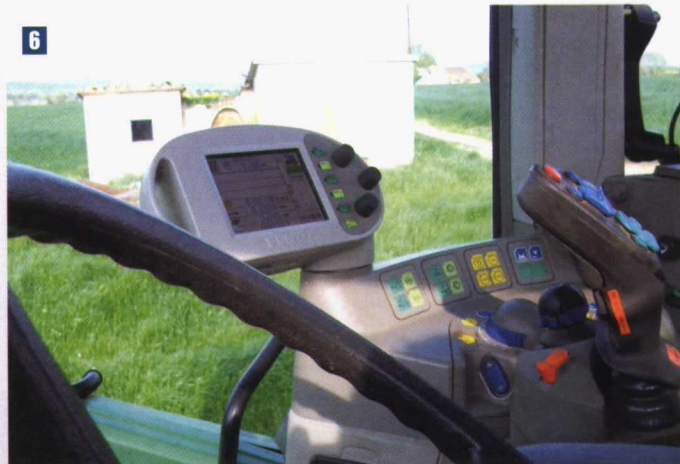
Foto 6. La pantalla de control del Fendt 712 ofrece al usuario información interesante y permite adecuar las condiciones de trabajo a las particularidades de cada situación.
