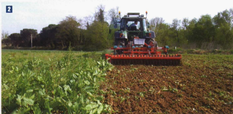
Foto 2. Imagen del chisel durante las pruebas. Se puede observar la gran capacidad de enterrado de los restos vegetales, especialmente cuando se seleccionan los parámetros adecuados de velocidad y profundidad de trabajo.
