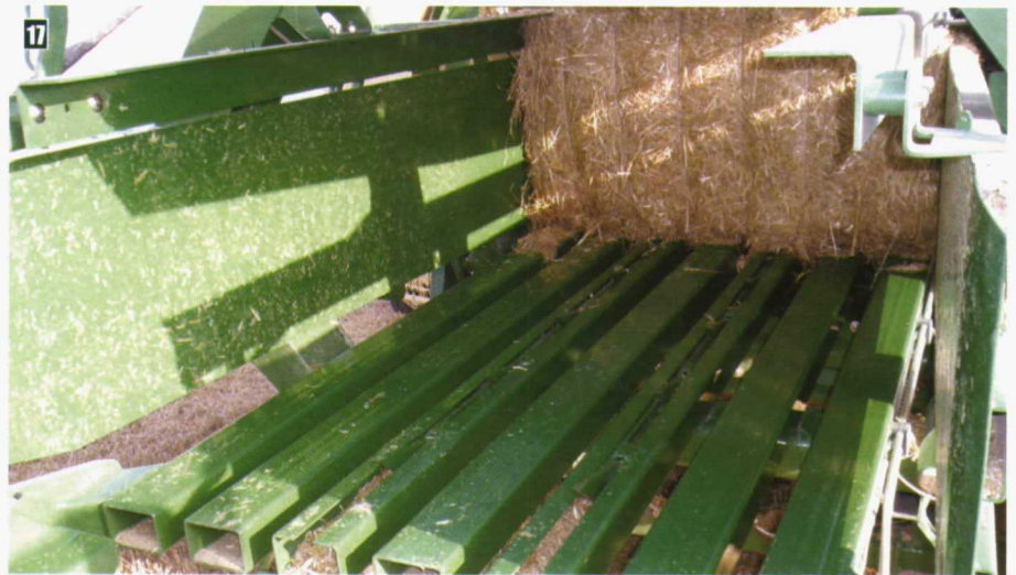
Fotos 17. Canal de compresión de una macroempacadora.
