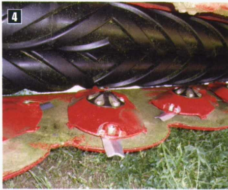
Foto 4. Discos corte y sistema acondicionador de rodillos. Foto 5. Segadora plegada para transporte.
