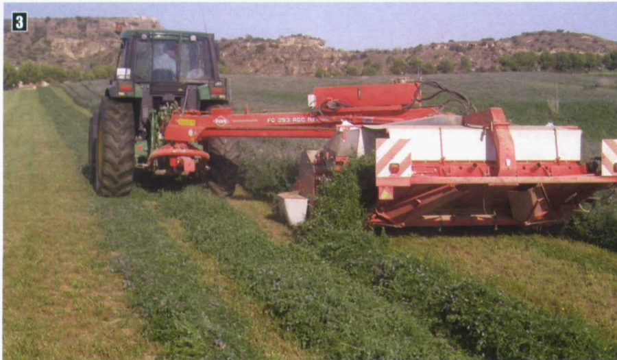
Foto 3. Segadora acondicionadora trabajando formando tres cordones de forraje agrupados utilizando cinta de hilerado lateral.
