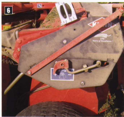
Foto 6. Sistema de regulación de la presión del cabezal de siega sobre el terreno.
