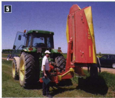
Foto 4. Discos corte y sistema acondicionador de rodillos. Foto 5. Segadora plegada para transporte.
