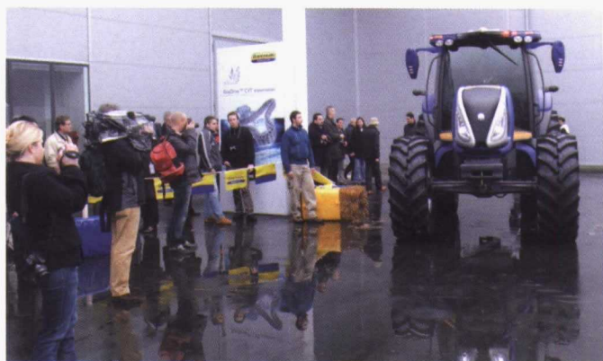
Dentro del diseño del NH 2 , destaca la integración de las luces de carretera como leds en la parte superior de la cabina.
