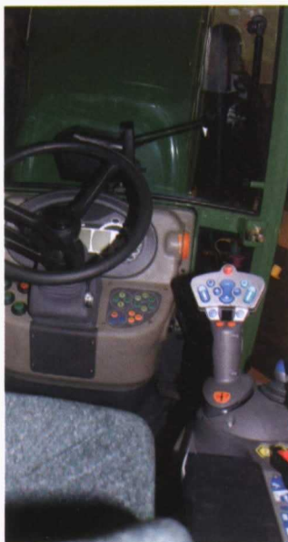
Desde el joystick multifunción se pueden manejar hasta cuatro válvulas.
