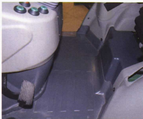
La serie 200 Vario monta la primera cabina del mercado con suelo plano que permite al conductor tener mayor libertad de movimiento.
