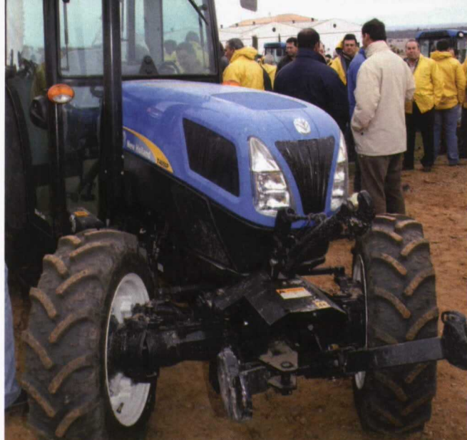
En esta nueva serie, sigue siendo primordial el eje delantero Supersteer con gestión automática de la doble tracción, que permite girar en un radio de tan solo 3,3 metros.
