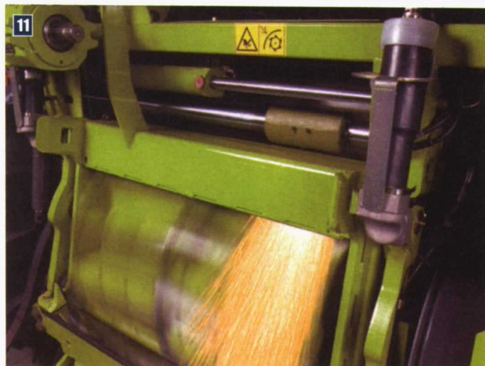
Foto 9. Rodillo picador de múltiples filas de cuchillas. Fuente: John Deere. Foto 10. Detalle de cuchillas y contracuchillas. Fuente: Krone. Foto 11. Afilado automático de cuchillas. Fuente: Claas. Foto 12. Apertura lateral del dispositivo de alimentación. Fuente: Claas.
