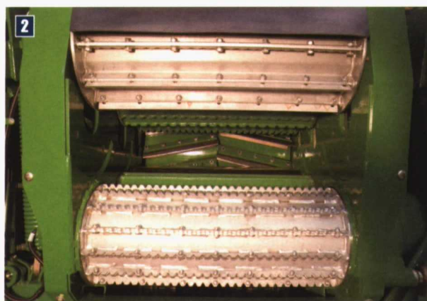
Foto 2. Rodillos del dispositivo de alimentación. Fuente: Krone.
