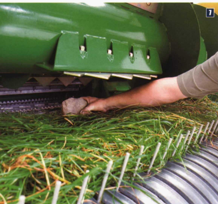
Foto 7. Retirada de elementos extraños en cabezal. Fuente: Krone
