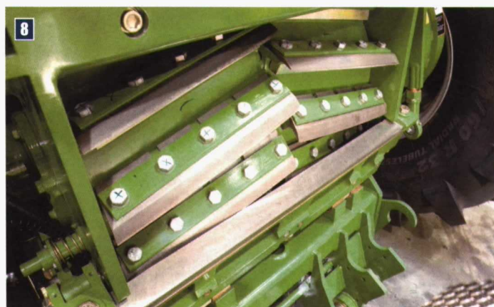
Foto 8. Detalle de rodillo picador y contracuchilla.
