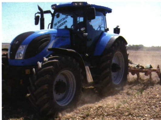
Izda. a derecha: Tractor Magnum 310 de Case IH de 345 CV de potencia realizando una labor de siembra con una sembradora neumática volumétrica. Tractor Landini Powermaster 200 realizando una labor de arado con un chisel de trece brazos y 4 m de ancho. Detalle de tomas hidráulicas exteriores.
