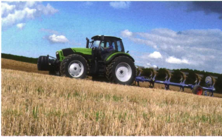
A la izquierda: Tractor Agrotion L 720 de Deutz-Fahr de 210 CV arando con una vertedera reversible de seis cuerpos. Foto dcha.: Tractor New Holland T8000 realizando labor de siembra nocturna.
