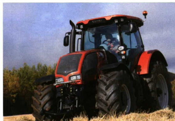
De arriba a abajo, izda. a derecha: Tractor JCB con enganche frontal equipado con tres segadoras. Tractor Same Diamond realizando una labor de vertedera. Tractor Massey Ferguson 7400 con remolque esparcidor de estiércol. Tractor de la nueva serie S de Valtra con potencias entre 270 y 370 CV y transmisión continua AVT.
